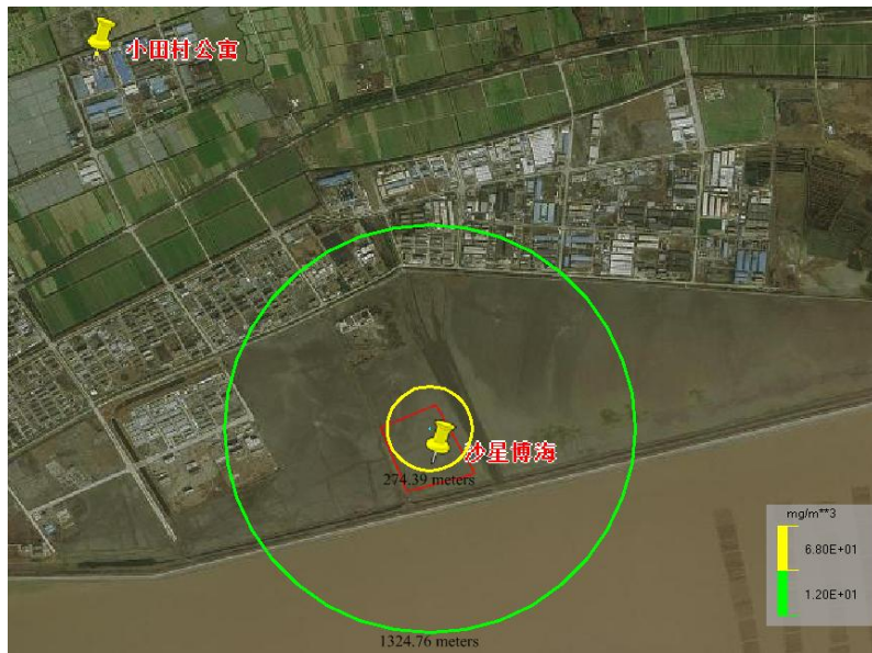
图 6.3.5-3 氯化亚砷储罐泄漏影响预测图
